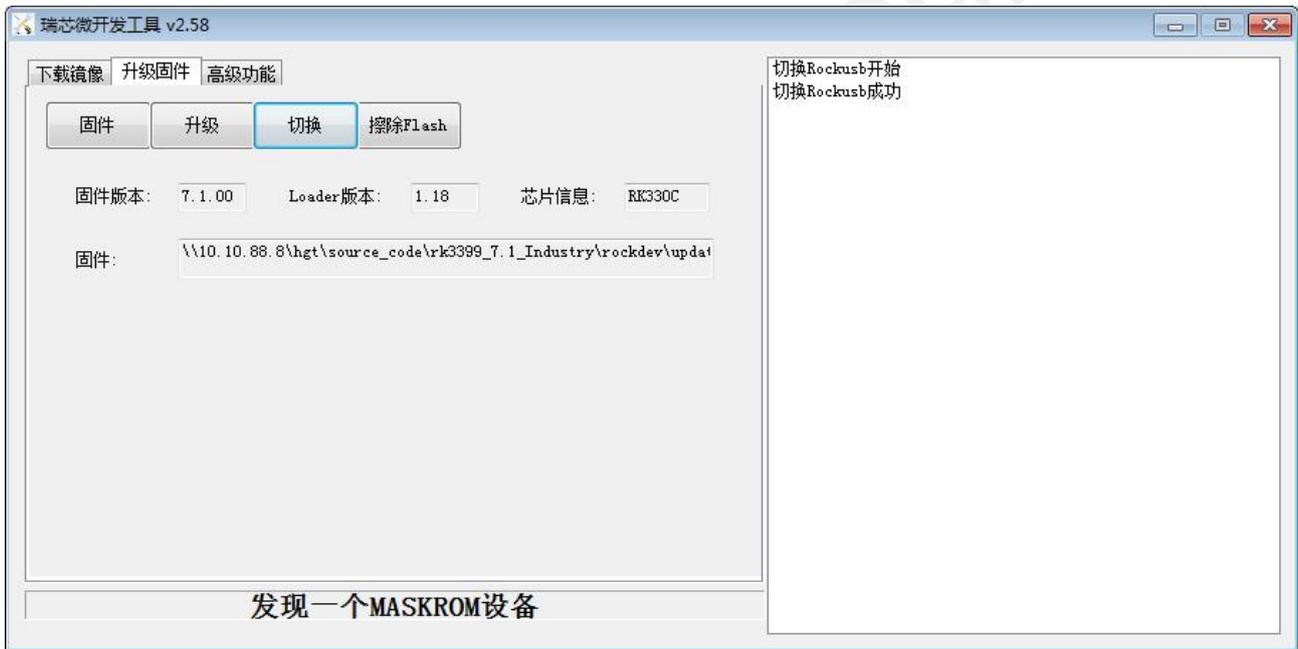
图4-3-1 进入Maskrom烧写模式工具上示意图
