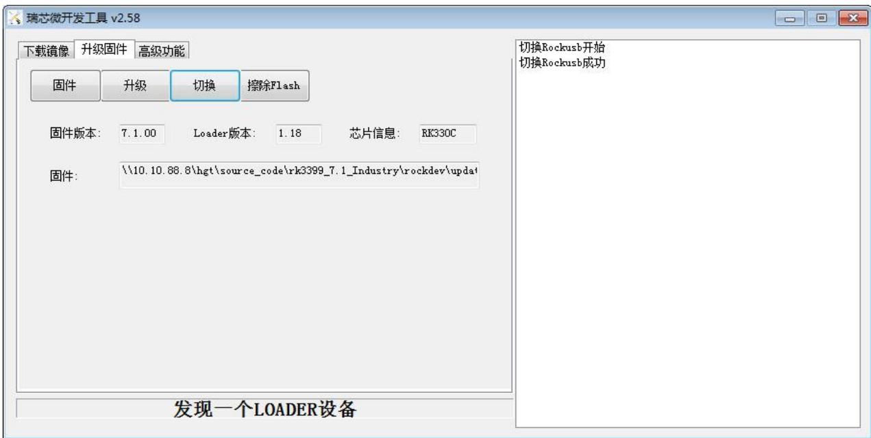
图4-3-2 进入Loader烧写模式工具上示意图
