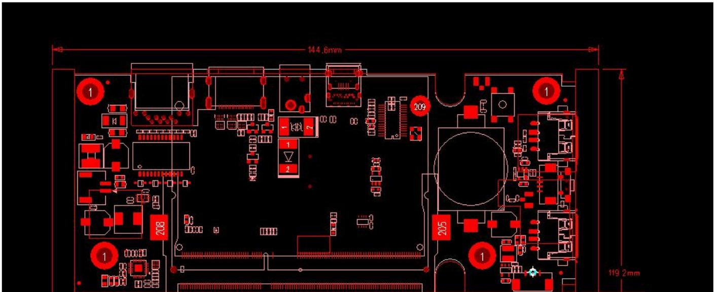
PCB 相关尺寸及规格:长 144.6MM、宽 119.2MM、厚 1.6MM，螺丝孔规格: 直径 3.0MM。
